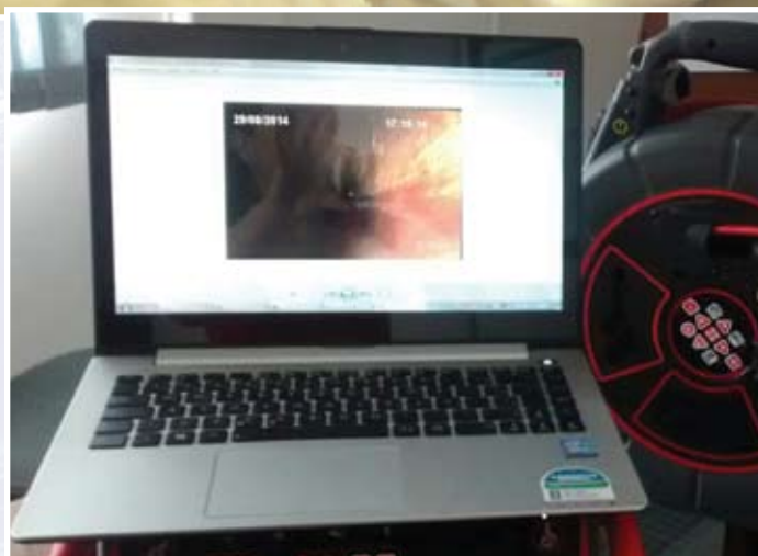
Trabalho em Catanduva (SP): Imagem da câmera mostra com clareza nível de incrustação.
